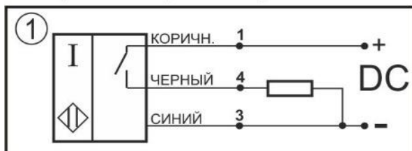
Схема соединения Нормально-разомкнутый контакт
