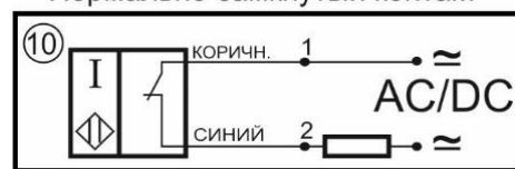
Цоколевка клеммной колодки
