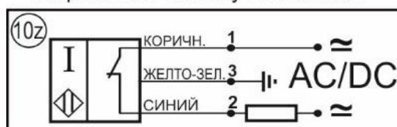
Цоколевка клеммной колодки
