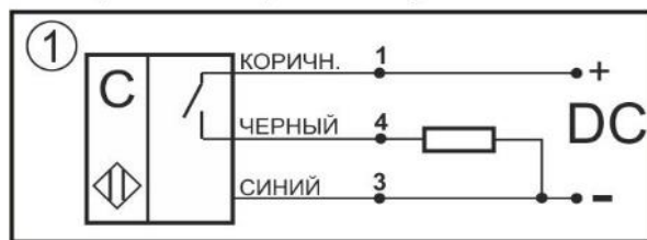
Схема соединения Нормально-разомкнутый контакт
